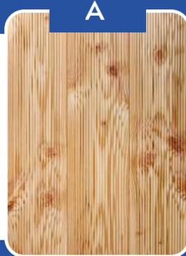
Legname sano, con lievi alterazioni cromatiche. Presenza di tasche di resina e nodi aderenti con diametro non superiore a 1/3 della dimensione minima di sezione (<4 cm).
